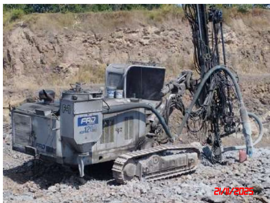
รูปที่ 25 เครื่องเจาะรูระเบิดที่มีอุปกรณ์เก็บฝุ่นติดไว้กับหัวเจาะ
